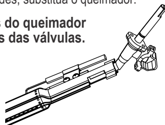
Encaixe correto Válvula-Queimador
